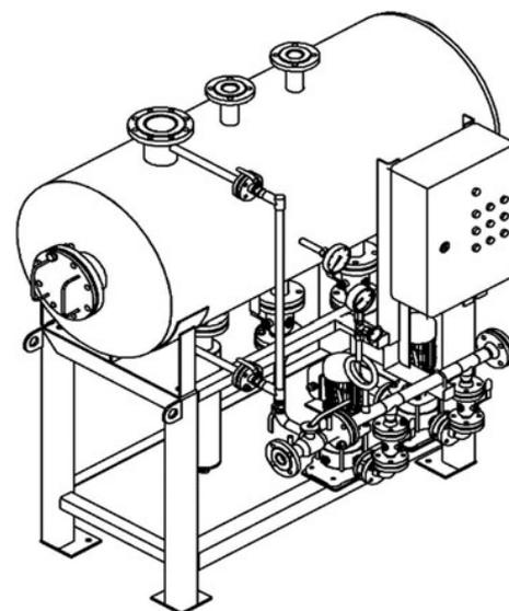
В линейку входят станции с ресиверами объемом 500, 1000 и 2000 литров.
