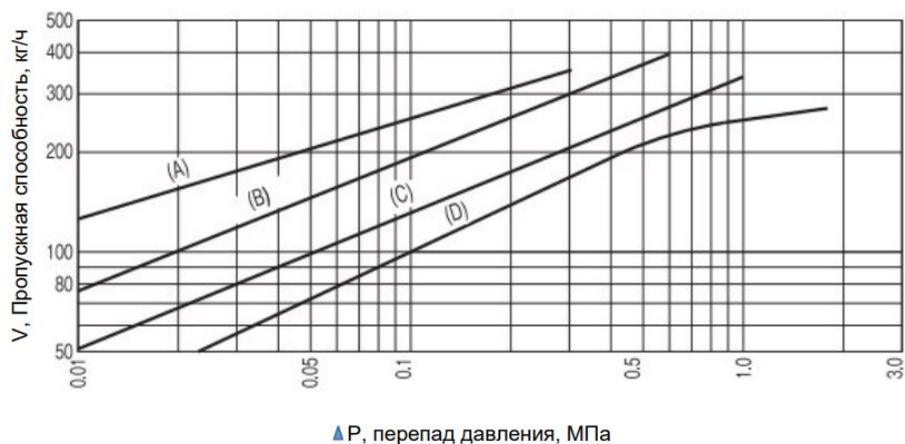
\* Показанная здесь пропускная способность является постоянной пропускной способностью при указанном перепаде давления.
