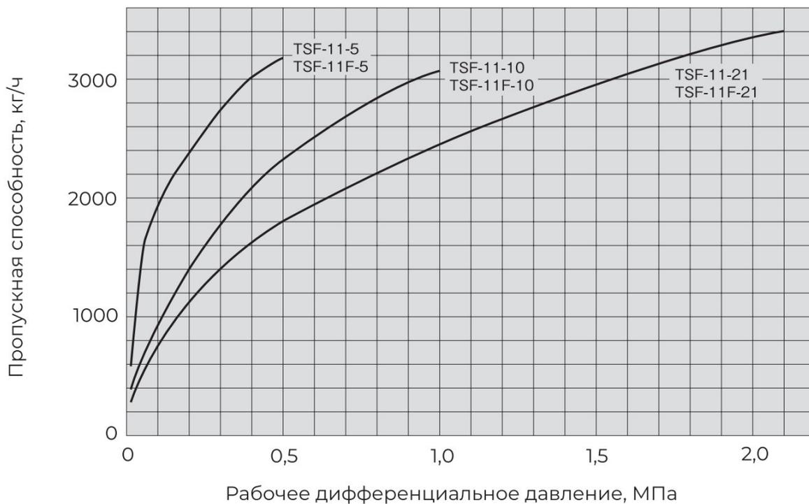
\*Пропускная способность, указанная на графиках выше, является максимальным значением. При проектировании системы выберите конденсатоотводчик с запасом.
