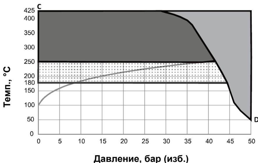
**C-D:** Кривая зависимости давления от температуры для углеродистой стали согласно ASME B16.34
