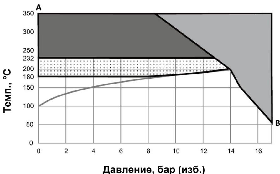
**A-B:** Кривая зависимости давления от температуры для высокопрочного чугуна с шаровидным графитом ASME B16.42
